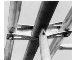
▲ 上部金具を上に取り上げ、建柵に水平に突きあてた状態。
